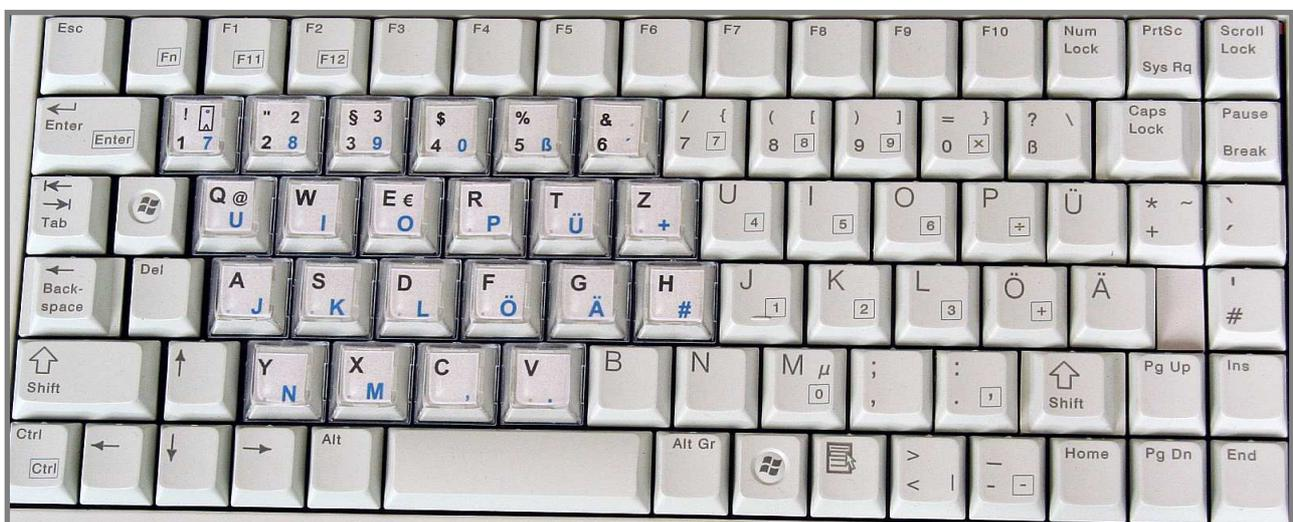
Bei der *Kompaktastatur 1-Hand rechts* ist die Umschaltung der Tasten <enter> und <backspace> mittels der Leertaste (trotz ihrer ev. vorhandenen blauen Beschriftung) nur bei Tastaturen mit Goldkontakten möglich. Bei dem Tastaturtyp ohne Goldkontakte werden die Tasten <^> und <Esc> durch Umschaltung der Tasten <F11> und <F12> erzeugt (siehe Beschriftungsstreifen).
