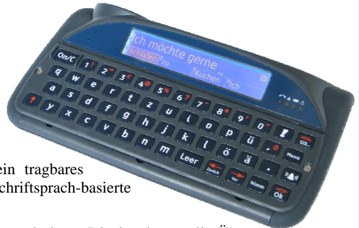
Der **kleine und handliche** LightWriter ist ein tragbares Kommunikationshilfsmittel, das eine schnelle schriftsprach-basierte Kommunikation ermöglicht.
