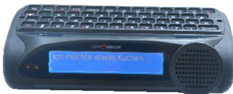
Die einfache integrierte Umfeldsteuerung ermöglicht bis zu acht Infrarotsignale anzulernen und zur Steuerung zu benutzen.
