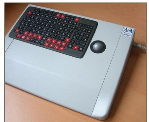
Diese Minitastatur wird mit einem Kabel an eine USB-Schnittstelle des Computers angeschlossen und mit den Standardtreibern (HID) genutzt.
